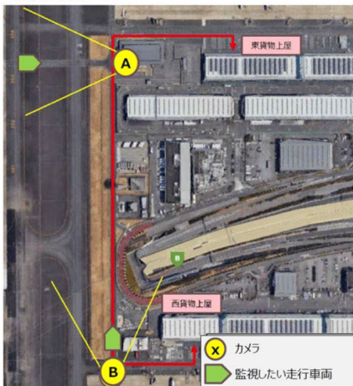
図1：A, B 各々の箇所は、車両搭載のカメラ等では検知出来ないものが多いため監視員と VME による補助が必要となる。
