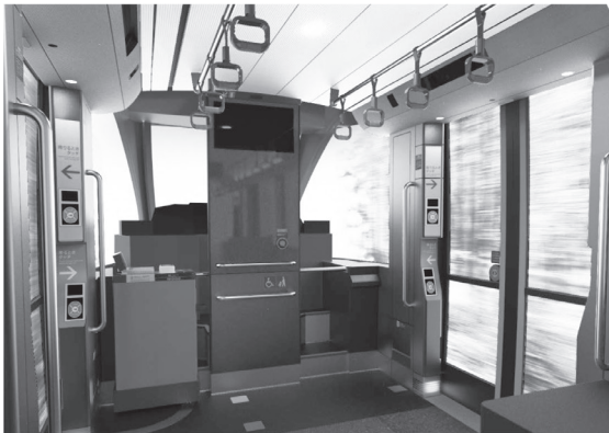
図2 全屏に設置されるカードリーダー
