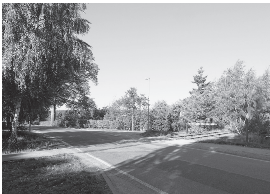
写真10 線路側に遮断機がある踏切
